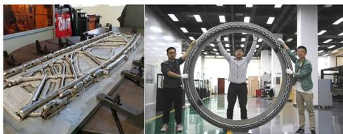
2米铝合金连接环和大尺寸飞机翼肋结构件
